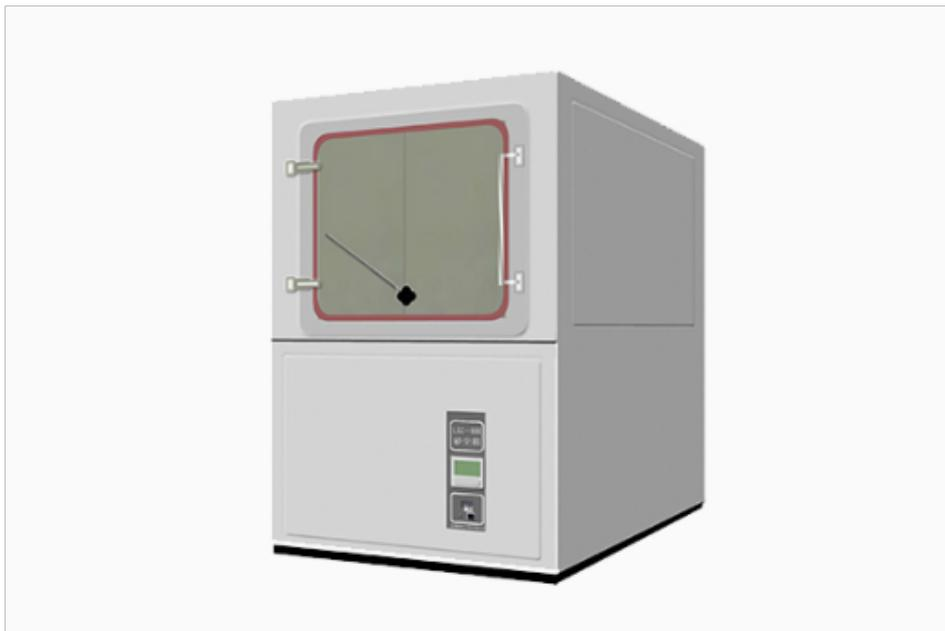
淋雨试验箱箱体结构箱体外壳材料采用好不锈钢板发纹处理，内胆材料采用不锈钢光板；2. 大面积可视玻璃门，便于观测试验箱体内被测试样状况；采用进口变频器控制转速有效保证试验按标准运行；试验箱底部采用高的品质可固定式PU活动轮，方便用户搬移；具有270度摆管和360度旋杆喷水装置；可调转速的样品台。淋雨试验箱适用于外部照明和信号装置及汽车灯具外壳防护，能够提供逼真的模拟电子产品及其元器件在运输和使用期间可能受到的淋水和喷淋试验等各种环境。以达到检测各种产品的防水性能。郑州民用砂尘试验箱现货高低温环境试验箱？联系无锡亿恒捷测试仪器有限公司。
